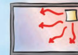
Mala ubicación. Partes de la vivienda permanecen frías y parte del calor se pierde al exterior, posibilidad de condensación
